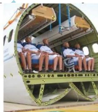
Figure 1 : Fuselage Drop test<sup>4</sup>
