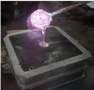
Fig:8, pouring of molten AMMC
